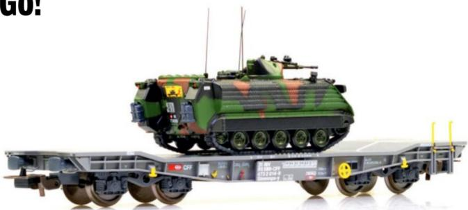
ges geboten. Bereits beim Verlad der Panzer auf der Rampe im Bahnhof ist sicherzustellen, dass der Fahrdräht – wenn vorhanden – geerdet ist. Besser noch, die Antennen werden abmontiert (diese werden beim Bahntransport eh nicht benötigt, da die Mannschaft nicht im Panzer mitfährt). Solche Unfälle haben sich in der Vergangen-
