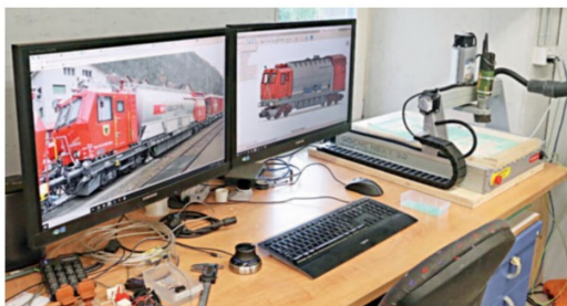
An CAD-Arbeitsplätzen werden die Einzelteile für das Modell entworfen.
