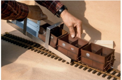
Sehr praktische vereinfachte Aufgleisung einer Gruppe von drei Fahrzeugen. Die Aluminiumrinne erleichtert die Arbeit erheblich.
