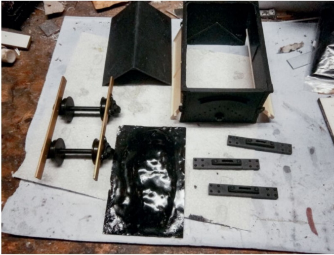
Die verschiedenen Wagenteile vor dem Entgraten und der Endmontage.
