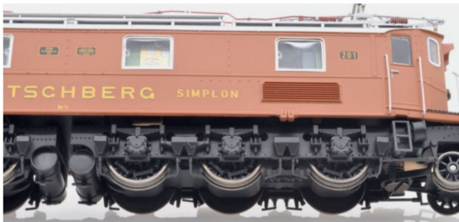
Detailvielfalt herrscht auch am Drehgestell, sowohl beim Rahmen als auch bei den Antriebsfedern.
