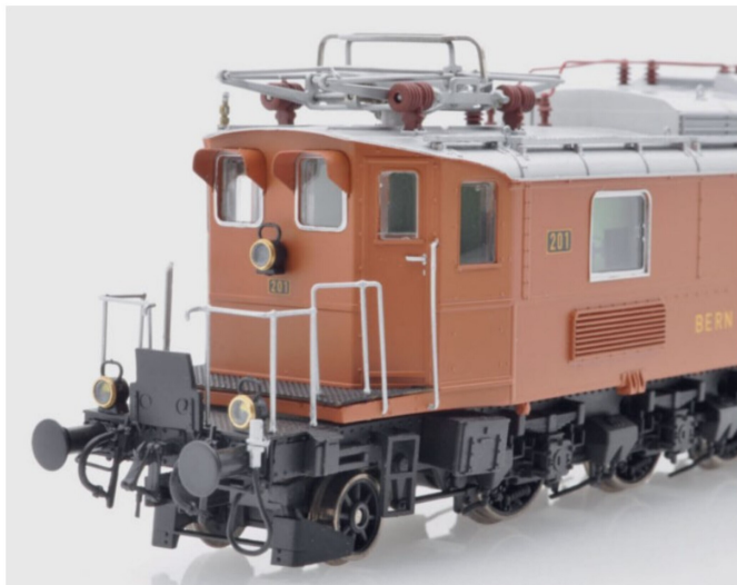
Ansicht der ab Werk zugerüsteten Front mit Bremsschläuchen und Heizleitung.
