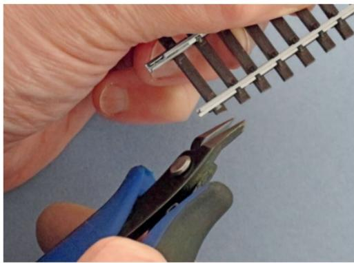
Wo zwei Gleisabschnitte zusammenlaufen, ist ein Trimmen der Kunststoffschwellen erforderlich. Zu diesem Zweck kann ein Schienenschneider von DCC Concepts oder Xuron verwendet werden. In der Regel muss nur eine Seite der Schwellen beschnitten werden.
