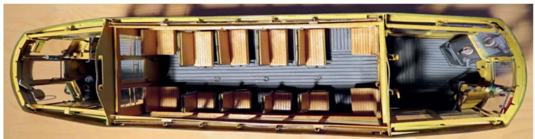
Ein Blick ins Innere des Motorwagens Be 2/2 177 zeigt die detaillierte Inneneinrichtung des Modells im Maßstab 1:22,5.
