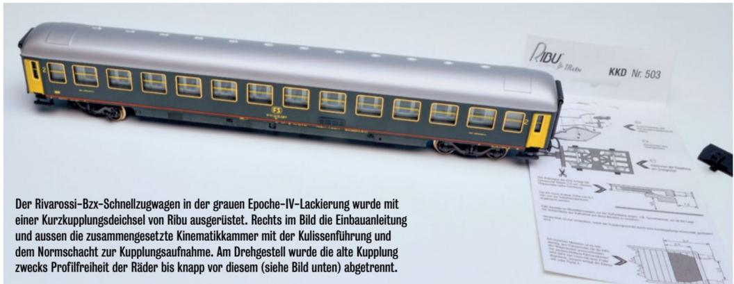
Der Rivarossi-Bzx-Schnellzugwagen in der grauen Epoche-IV-Lackierung wurde mit einer Kurzkupplungsdeichsel von Ribu ausgerüstet. Rechts im Bild die Einbauanleitung und aussen die zusammengesetzte Kinematikkammer mit der Kulissenführung und dem Normschacht zur Kupplungsaufnahme. Am Drehgestell wurde die alte Kupplung zwecks Profilfreiheit der Räder bis knapp vor diesem (siehe Bild unten) abgetrennt.
