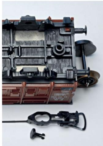
Bevor der Fräskopf zum Einsatz kommt, sind die Radsätze sowie die Standardkupplung samt ihrer Halterung am Wagenboden abzunehmen.
