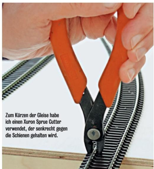
Zum Kürzen der Gleise habe ich einen Xuron Sprue Cutter verwendet, der senkrecht gegen die Schienen gehalten wird.
