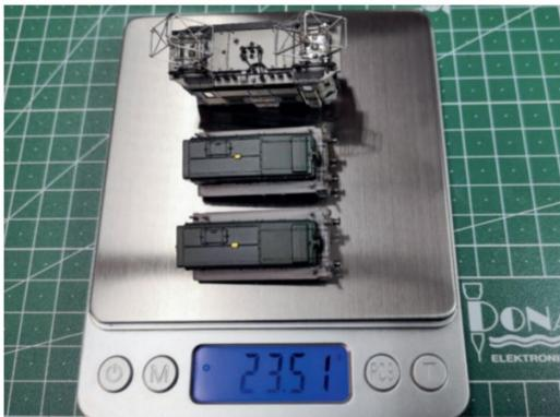
Dank «mit Metall gefülltem Kunststoff» wiegt das neue Gehäuse mehr als ...
