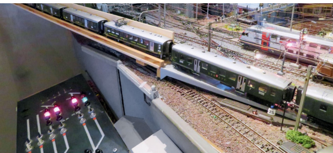
Mit der selbst entwickelten Vorrichtung können ganze Züge zwischen der Anlage und den Regalelementen der Zugsvitrinen verschoben werden.
