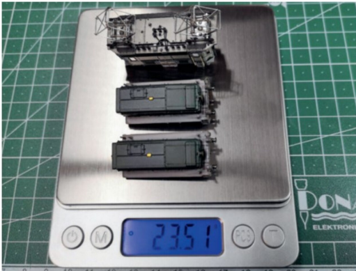
Dank «mit Metall gefülltem Kunststoff» wiegt das neue Gehäuse mehr als ...
