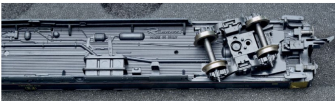
Die eingeklebte Ribu-Kurzkupplungsdeichsel mit Roco-KK-Kopf. Profilfrei das Drehgestell.
