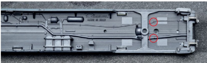
Mit einem Marker wurde die Fräsgrenze an den beiden Leitungen an einer Seite markiert.
