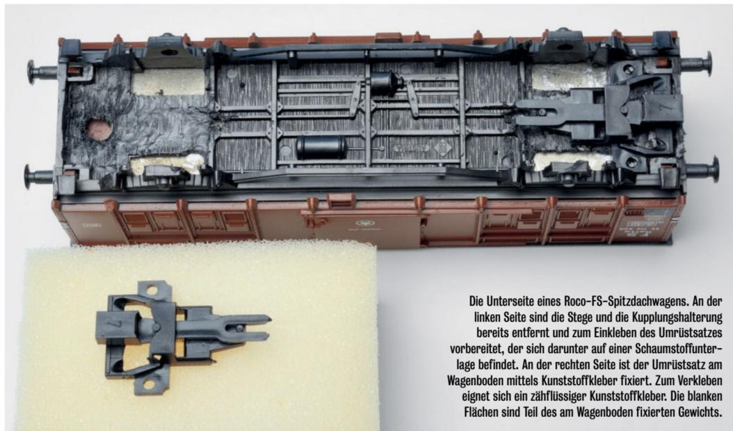
Die Unterseite eines Roco-FS-Spitzdachwagens. An der linken Seite sind die Stege und die Kupplungshalterung bereits entfernt und zum Einkleben des Umrüstsatzes vorbereitet, der sich darunter auf einer Schaumstoffunterlage befindet. An der rechten Seite ist der Umrüstsatz am Wagenboden mittels Kunststoffkleber fixiert. Zum Verkleben eignet sich ein zähflüssiger Kunststoffkleber. Die blanken Flächen sind Teil des am Wagenboden fixierten Gewichts.
