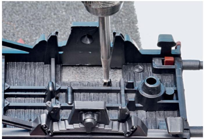
Der Fräskopf ist zum Einsatz bereit. Alle Stege, die sich vom Wagenboden abheben, – ausgenommen jene, welche die Gehäusehalterung umschließen – und die relativ hoch aufragende Kupplungshalterung müssen entfernt beziehungsweise plattfräst werden.
