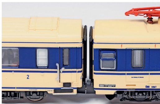
Kuppelabstand mit der elektrisch leitenden PEHO-Magnetkupplung.
