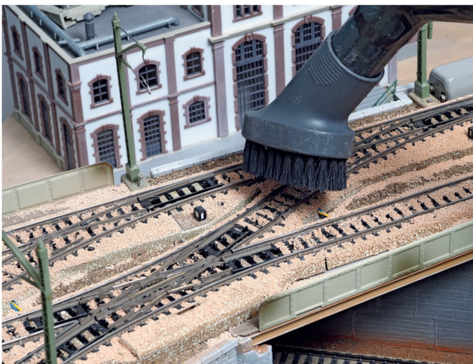
Nach dem Trocknen werden im Bereich der Weichenzungen nicht haftende Schotterkörner abgesaugt.
