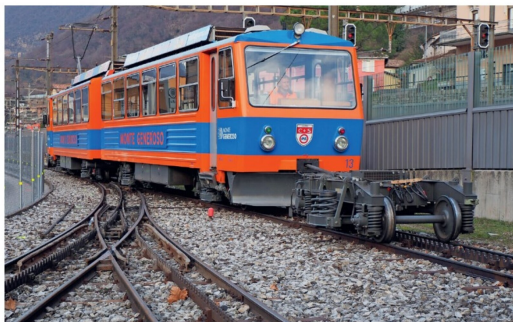
Triebwagen 13 manövriert ein Drehgestell des Bruders 12 in jenes Remisengleis, das mit einer Wascheinrichtung ausgerüstet ist.
