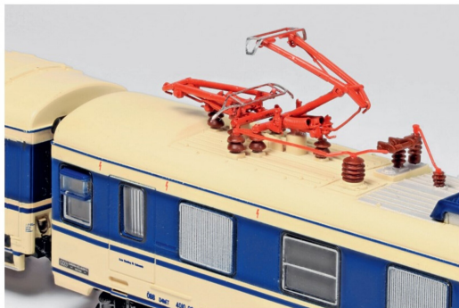
Die zwei unterschiedlichen Stromabnehmer des Transalpin 4010.06.
