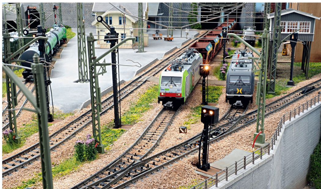
Fahrversuche mit der kürzesten Lok decken die noch zu wenig gereinigten Stellen auf, sei es bei den Punktkontakten oder bei den Gleisköpfen.
