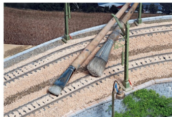
Mit verschiedenen Pinseln wird das Schotterbett in eine originalgetreue Form gebracht.
