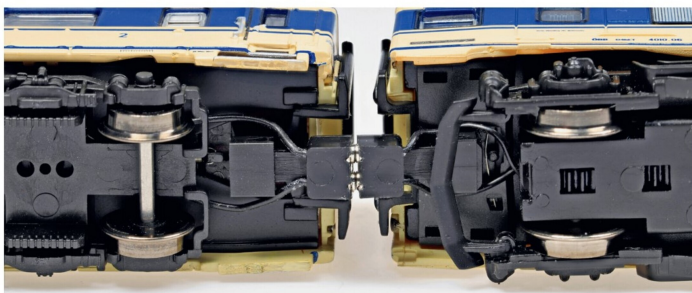
Die elektrisch leitende magnetische Kurzkupplung von PEHO sorgt für kurze mechanische Verbindung.
