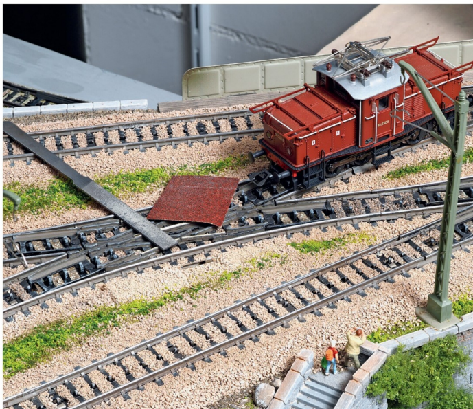
Fahrversuche mit der kürzesten Lok decken die noch zu wenig gereinigten Stellen auf, sei es bei den Punktkontakten oder bei den Gleisköpfen.
