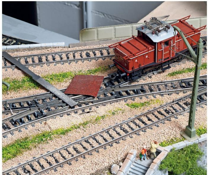
Fahrversuche mit der kürzesten Lok decken die noch zu wenig gereinigten Stellen auf, sei es bei den Punktkontakte oder bei den Gleisköpfen.
