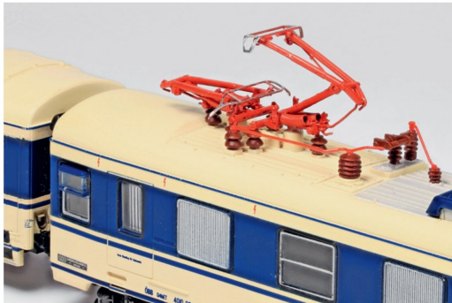
Die zwei unterschiedlichen Stromabnehmer des Transalpin 4010.06.
