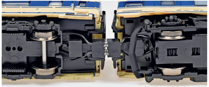
Die elektrisch leitende magnetische Kurzkupplung von PEHO sorgt für kurze mechanische Verbindung.
