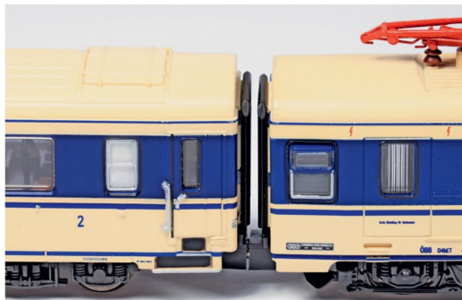
Kuppelabstand mit der elektrisch leitenden PEHO-Magnetkupplung.
