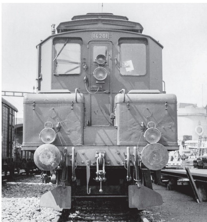
Späte Errungenschaften: Stirnwandtüre verschweisst mit kleinem Fenster und ohne Übergangsbleche.
