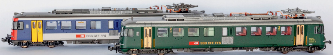
Ein Stelldichein der beiden bisher ausgelieferten RBe-Triebwagen von PIKO. Deutlich sichtbar ist die besser kaschierte, schwenkbare Schürze beim RBe 540.
