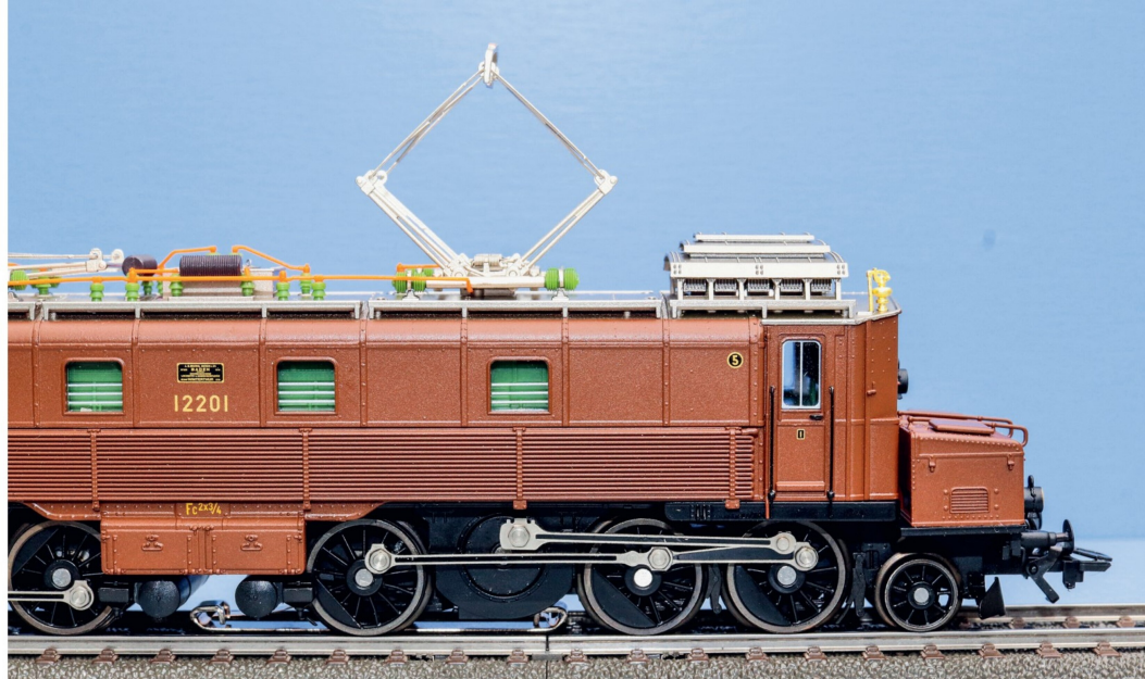
Auf einen Blick sind die sauber detaillierte Lokhälfte mit den Rohrschlangen der Kühlung, den Dachaufbauten und des Fahrwerkes ersichtlich.
