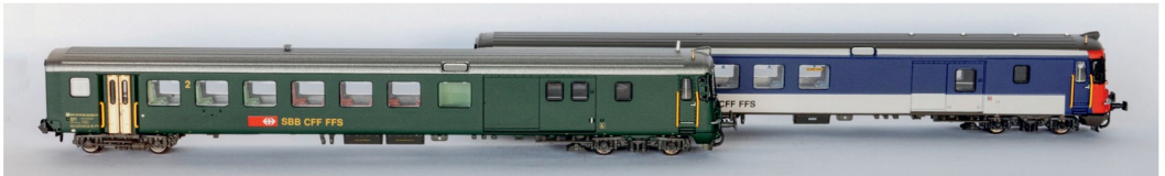
Die beiden Bdt EW II im Direktvergleich. Gut sichtbar sind die geänderten Gepäcktüre, die unterschiedliche Fensteranzahl und der angepasste Unterboden.
