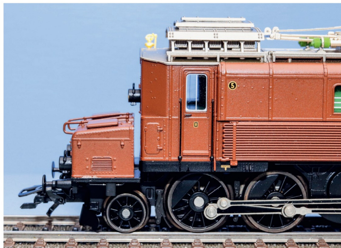
Diese Ansicht zeigt die Front mit der Stirnwandtür und dem getrennten Vorbau mit dem Übergangsblech.
