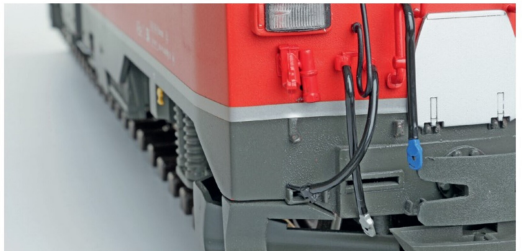
Abnehmbare Modellkupplung und verschliessbare Frontschienenräumer.
