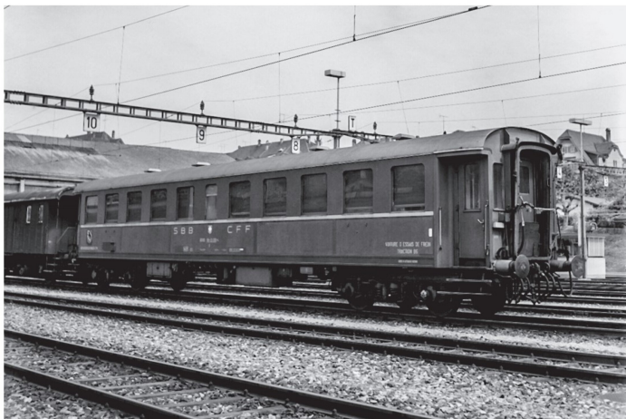
Immer dabei: der legendäre Berner Bremsversuchswagen X 60 85 99-33 200-4 der SBB.
