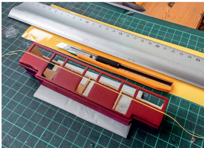
Nach dem Lackieren werden die gelben Zierlinien aufgebracht. Klarlack schützt die Decals.
