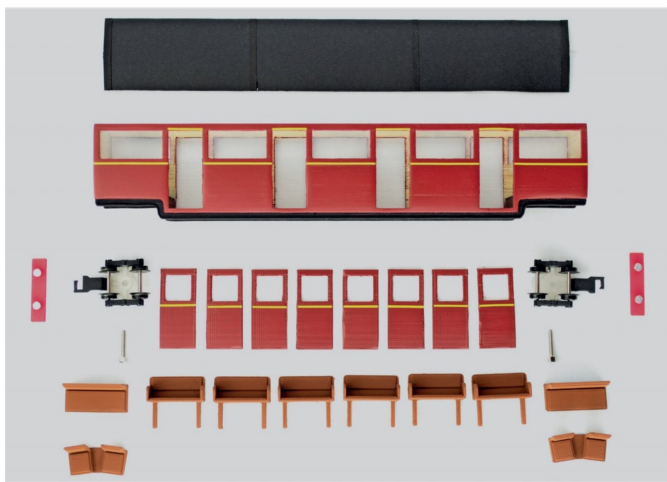
Die fertig bearbeiteten Einzelteile eines «20-seater saloon» sind bereit für die Montage.
