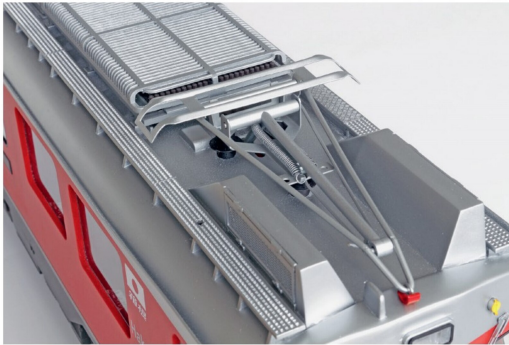
Ein in Mischbauweise aus Metall und Kunststoff gefertigter Stromabnehmer.
