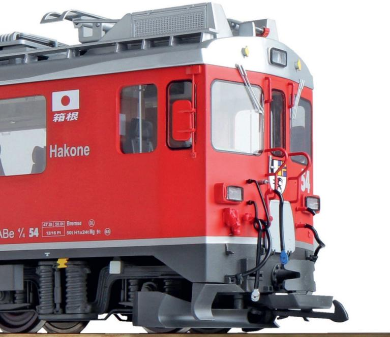
laubt, zwei Wagen aus derselben Serie in Doppeltraktion verkehren zu lassen. Aber auch gemischte Traktionen mit den ABe 4/4" und den Gem 4/4 sind uneingeschränkt möglich. Eine Doppeltraktion aus zwei ABe 4/4" darf die maximale Zughakenlast von 140 Tonnen befördern, theoretisch liegen gar 190 Tonnen drin.
