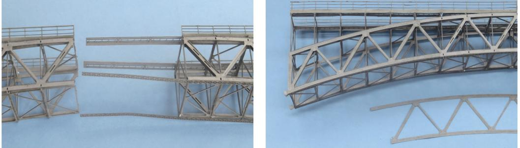
Nachdem die beiden Brückenhälften miteinander verbunden sind, werden die genieteten Detailabdeckungen auf die Trägerseiten geklebt.
