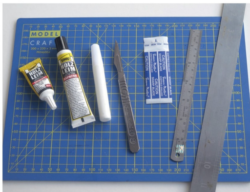
Die Kleinstausstattung für den Bau sind ein Schneidebrett, ein Bastelmesser mit Ersatzklinge, schnell trocknender Klebstoff und ein Stahllineal.
