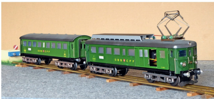
Für den BDe \frac{1}{4} wurden benötigt: ein Personenwagen 8625, ein halber Gepäckwagen 8623, zwei Lokfronten 304 sowie zwei Lokdächer. Selbstverständlich weisen sie ein drittes Spitzenlicht auf.
