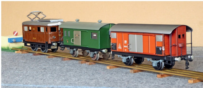
Der K 2 hat ein Bremserhaus (Webtrain) und Lüftungsschieber aus dünnem Alublech erhalten. Der Postwagen ist aus einem Gepäckwagen 8672 auf einem 18-cm-Chassis mit Plattformgeländer von 8683 entstanden.
