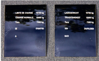
Siebdruck von Anschriften auf Messingplatten.
