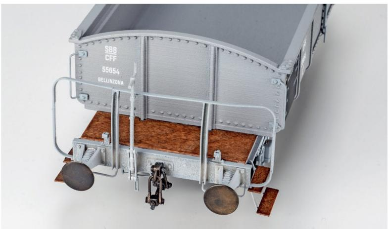
Detailansicht der Bremserplattform. Die Holzteile der Bodenbretter und Tritte sind aus gelasertem Holz.
