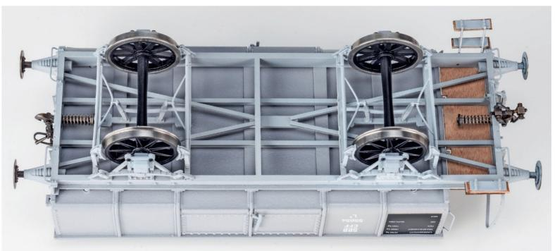
Ein Blick unter den Wagenboden zeigt sämtliche Details des Untergestells und des kompletten Fahrwerks.
