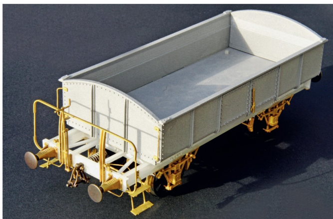
Das Endmodell zeigt sich hier mit 3-D-FUD-Teilen, 3-D-Alulegierung und Messingussteilen.
