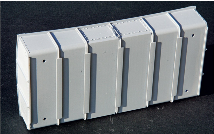
Der in FUD gedruckte Wagenkasten zeigt sich mit einer Grundierung lackiert.
