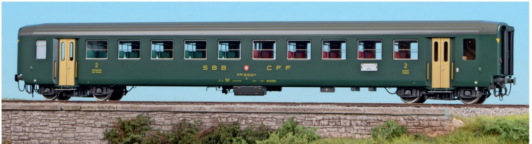
Der Zweitklasswagen mit UIC-Beschriftung, Gummiwülsten und Übersetzfenstern ist im Zustand nach 1975 und entstammt einer Serie von 25 Wagen.
