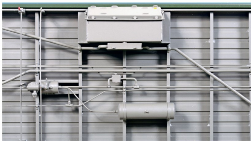
Bremseinrichtung, Längs- und Querträger entsprechen genau dem Vorbild.
