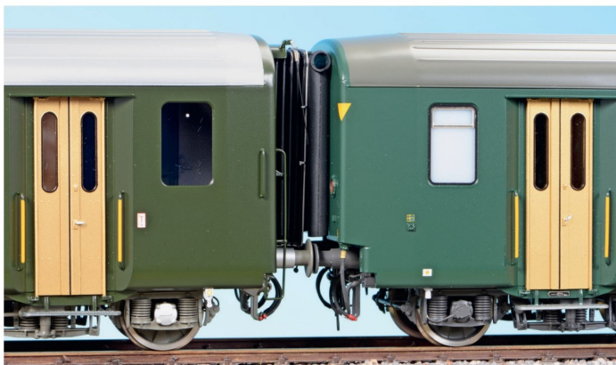
Die Epochenunterschiede auf einen Blick: Faltenbalg vs. Gummiwulst, Kastenlänge bzw. Endformen sowie die Farben des Wagenkastens, des Dachs, der Puffer und der Drehgestelle.
