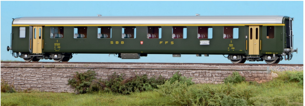
Typenaufnahme des Erstklasswagens A4 2558 der SBB in der Ursprungsausführung noch in der alten Farbgebung und mit Faltenbälgen.
