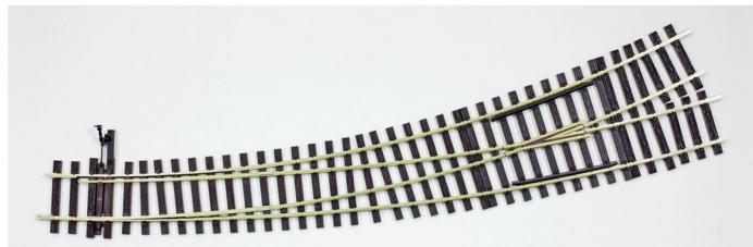
Kürzlich ausgeliefert wurden zwei Bogenweichen in Spur 0 – sie werden von der Firma PECO für Lenz gefertigt. Jeweils eine linke (Art.-Nr. 45034) und eine rechte Bogenweiche (Art.-Nr. 45035). Die Weichen sind ohne Antrieb, dieser kann nachgerüstet werden. Der Radius des abzweigenden Gleises entspricht R2 (1028,70 mm), der Kreisausschnitt des Stammgleises ist 18,75°.
