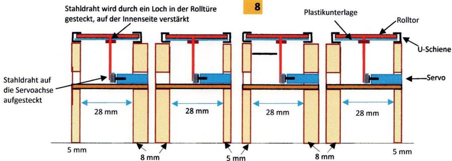
**7. Grundriss eines Rolltores (hier das Rechte Tor eines Moduls)**
