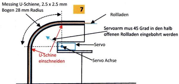
**6. Schnitt durch die 4 Einbaukörper mit fertig eingebautem Servo, von der Innenseite her gesehen**
