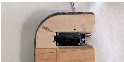
Die Zwischenwand aus Sperrholz mit Servo vor dem Einbau.
