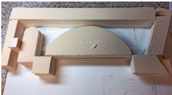
Mittels Styrodur von 40 mm Dicke wird eine Giessform des Steinbogen-Brückenteils hergestellt.
