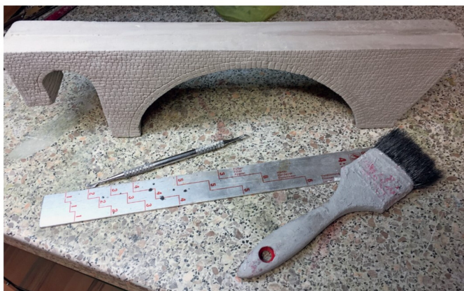
Noch bevor der Gips komplett aushärtet, werden in geduldiger Handarbeit die Steine eingeritzt.
