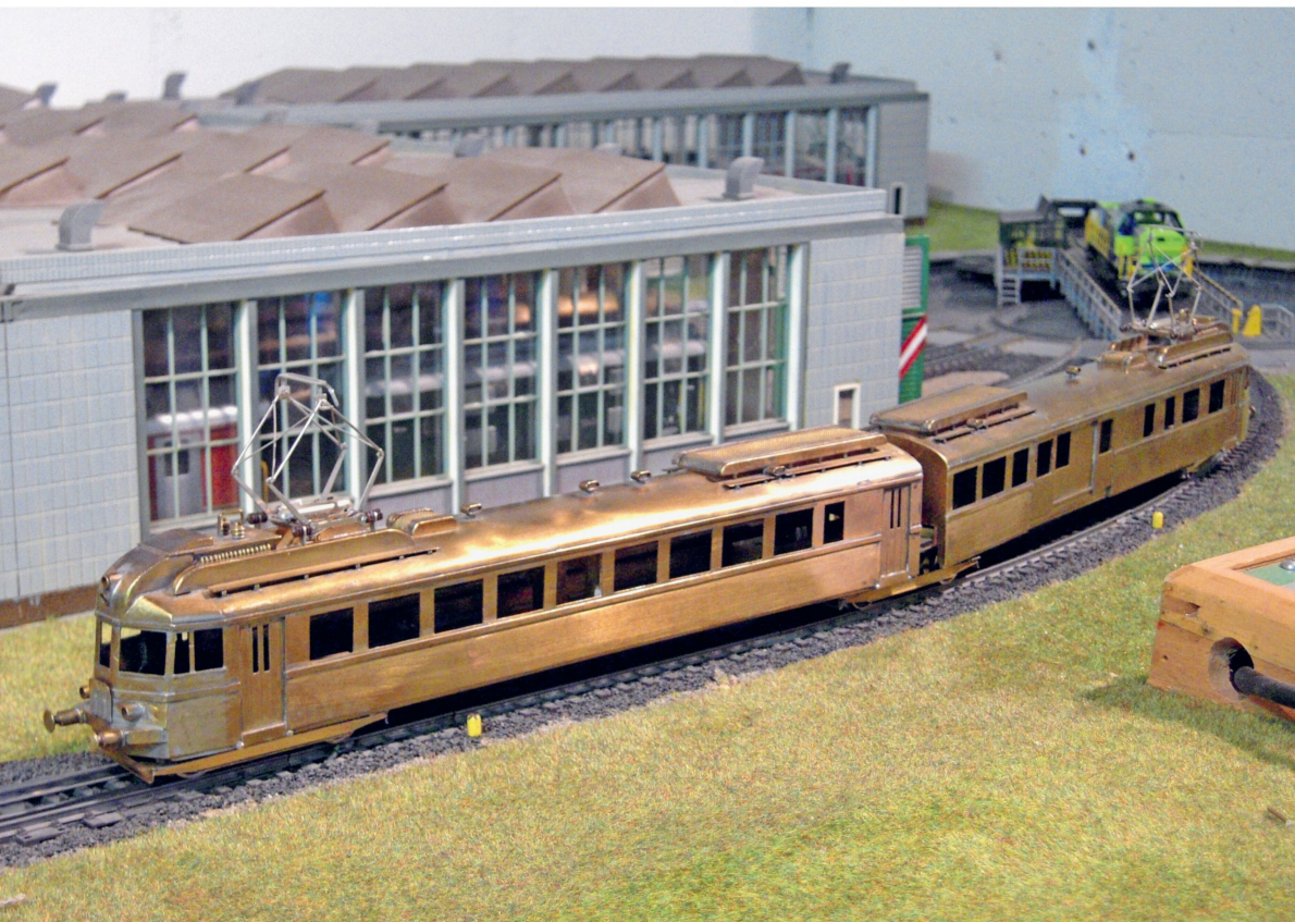
Der BCFe 4/6 736 in H0 macht während des Baus eine Probefahrt. Die Wagenkästen sind aus Messing gefertigt, während der Antrieb von Märklin stammt.
