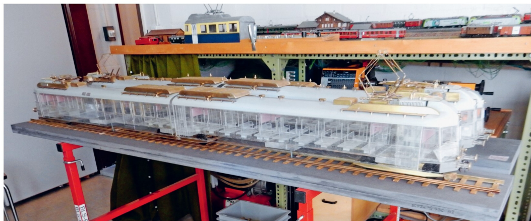
Die rohen Modelle des BCFe 4/6 im Massstab 1:25 während des Baus. Deutlich erkennbar sind die in Messing gehaltenen Teile.
