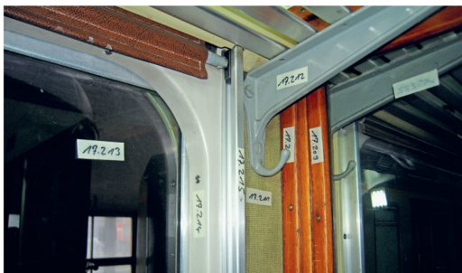
Alle Fahrzeugteile wurden vor dem Ausbau nummeriert und fotografiert.
