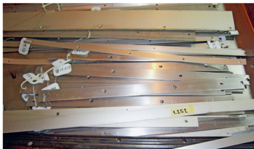
Aluminiumabdeckungen, nummeriert und gereinigt für den Wiedereinbau.
