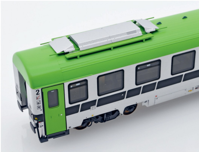
Ein Blick auf das Dach des Modells mit dem auffälligen Dieselaggregat.
