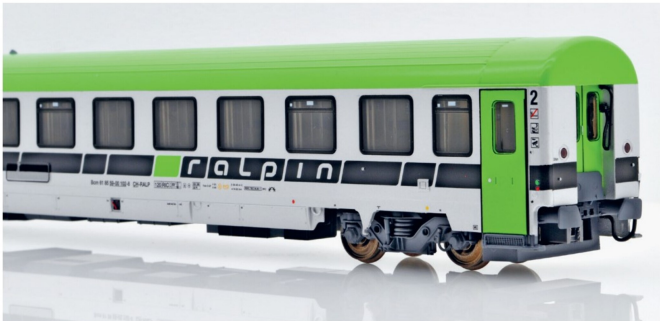
Das Wagenende ohne den üblichen Gummiwulst auf der Stirnseite.
