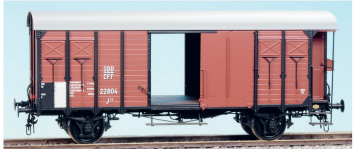
Die Wagenböden im Innern sowie die Trittbretter sind mit echtem Holz belegt.
