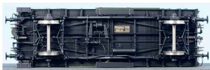
Er war bis am Ende seiner Einsatzzeit mit Leitungen für Dampf- und Elektroheizung ausgerüstet.
