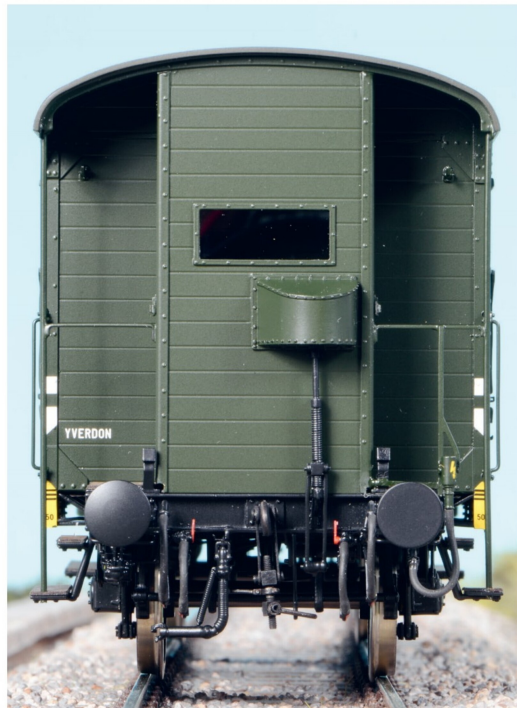
Typisch für diese Wagen war die links liegende Bedienung der Handbremse.
