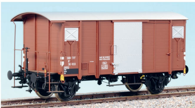
Dank der Zugsammelschiene konnte dieser K2-Güterwagen auch in Personenzügen verkehren.
