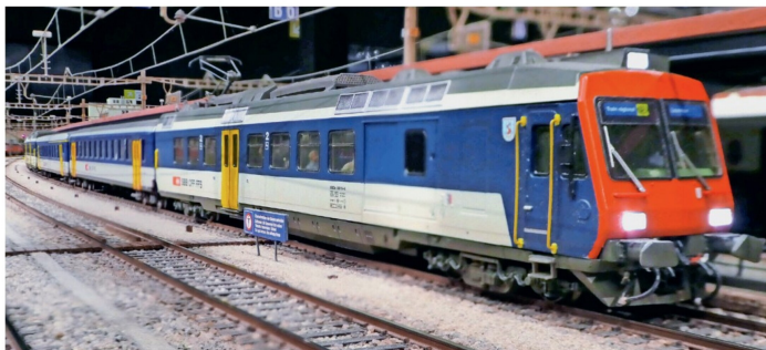
RBDe 560, 73 t, 1,65 kW; Last: 12 Achsen, Total 269 Plätze, V/max. 140 km/h.
