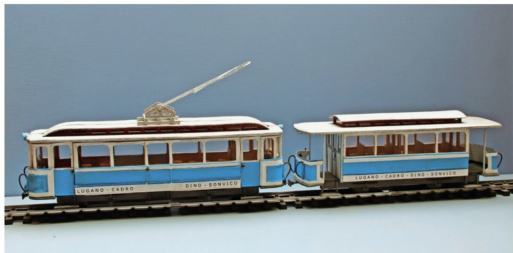
Das Modell zeigt einen LCD-Zug einige Monate nach der Eröffnung 1911. Der Triebwagen noch als Ce 2/2, also zweiaxsig, mit Lyrbügel.
