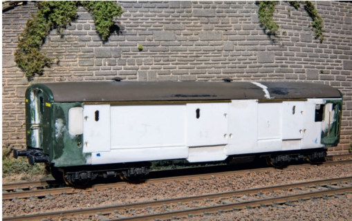
Der Postwagen ist hier im Rohbau fertig. Gut zu erkennen sind die verschiedenen Messingteile wie z.B. die Geländerstangen beim Wagenübergang.
