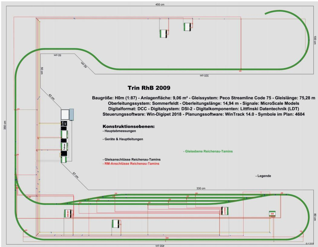
Auf nur eine Gleisebene und einen Stromkreis begrenzt, wird aus dem Kabelsalat eine klare Sache, hier sind die Gleis- und Rückmeldeanschlüsse des Schattenbahnhofs Reichenau-Tamins zu sehen. Nur diejenigen der grün-weissen Kästchen, auch Rückmelde- und Kehrschleifenmodule genannt, die mit (roten) Rückmeldeadressen beziffert sind, spielen in dieser Schaltung eine Rolle, ebenso nur der Booster «Fahren».
