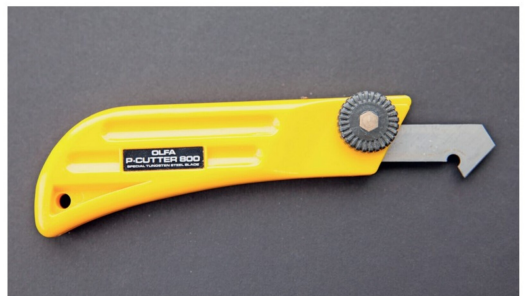
Der Cutter eignet sich bestens, um Rillen in Polystyrol Platten zu ritzen.
