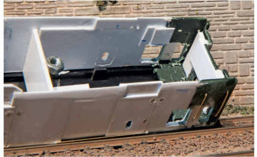
Ein Bild von unten, damit man sehen kann, wie ich den Wagen im Innern gebaut habe, insbesondere die Verschiebung der Türe nach innen.
