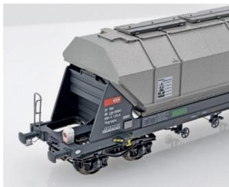
Als Ergänzung zu den bereits früher ausgelieferten Getreidesilowagen des Typs Tagnpps von SBB Cargo bietet nme die Wagen nun auch ausgerüstet mit einem Schweizer Zugschlussblinker an. Der Wagen verfügt über einen Funktionsdecoder, womit die Zugschlussbeleuchtung ein- und ausgeschaltet werden kann. Die Kabelführung erfolgt unsichtbar im Wagenrahmen, die Stromabnahme in den Drehgestellen und die Übertragung auf den Wagenkasten erfolgt über kaum sichtbare Kupferbleche.
