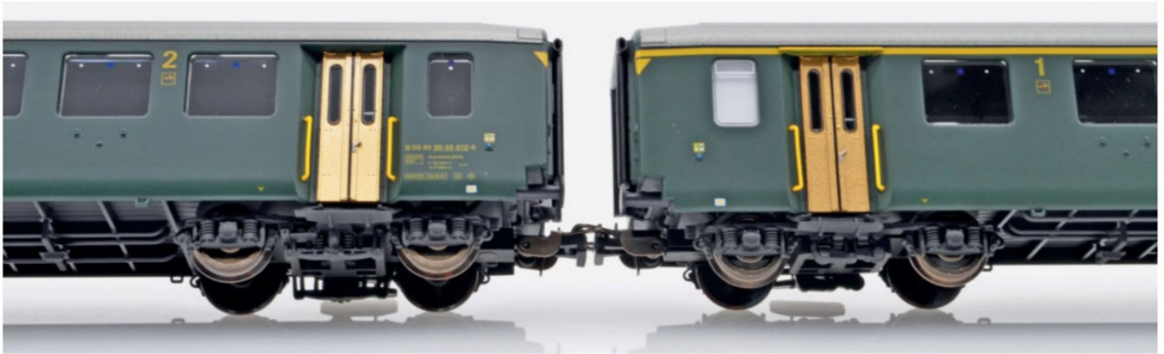
Korrekte Umsetzung der Drehgestelle sowohl mit Torsions- (rechts im Bild) als auch mit Schraubenfedern (links im Bild).
