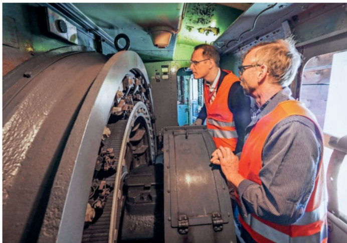
Enrico Pirovino erklärt in der Ge 2/4 205 dem RhB-Direktor Renato Fasciatti den seltenen Déri-Motor.
