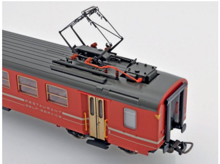
Die markanten Dachaufbauten beim Speisewagen: Stromabnehmer und Transformator.
