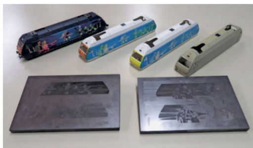
Die Bedruckung der Sondermodelle erfolgte in mehreren Arbeitsschritten, wie hier bei der Re-460-Werbelokomotive «Space Dream».
