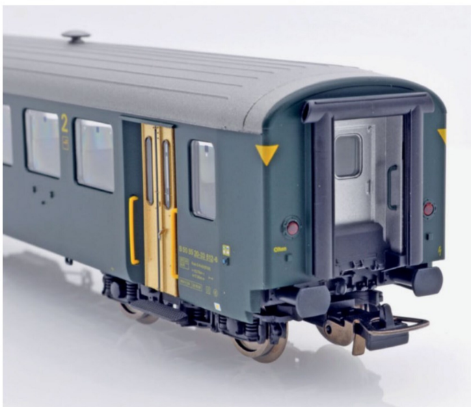
Das Wagenende mit Gummiwulst, Übergangsblech und separat eingesetzten Schlussleuchten.
