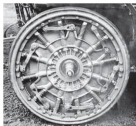
Das Metalfederrad als Pneuersatz.
