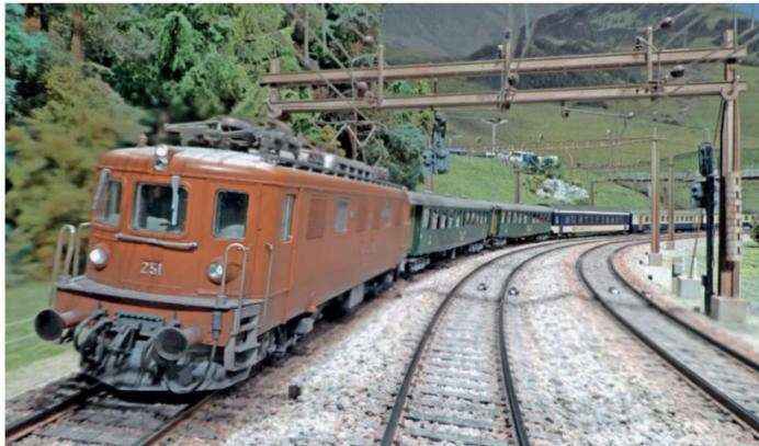
Ae 4/4, 2,94 MW, 80 t, Last: 20 Achsen, 334 Plätze, 181 t, V/max 125 km/h.
