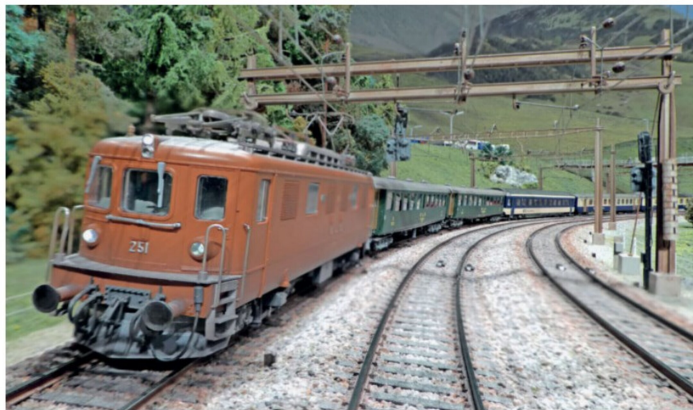
Ae 4/4, 2,94 MW, 80 t, Last: 20 Achsen, 334 Plätze, 181 t, V/max 125 km/h.
