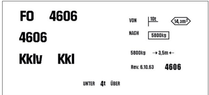
Skizze 5: Vorlage für die Herstellung der Anreibefolie zur Beschriftung des FO Kkl 4606.
